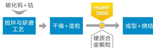
在硬质合金金属颗粒生产过程中，精确监测和控制颗粒中携带的水分是生产过程中的一项重要任务。只有进行连续性水分检测并实现受控干燥工艺，才有可能在诸如成型和烧结等下一道工序实现颗粒的工艺处理。
