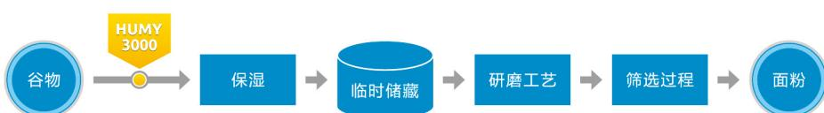
在面粉生产中，精确监测和控制谷物中携带的水分是生产工艺的一项重要任务。如果谷物过早干燥就会发生干裂，并且会在研磨工艺中产生大量多余的粉尘。如果谷物过于潮湿，则会降低研磨质量。只有通过精确在线水分检测和受控保湿工艺才能确保谷物水分含量保持最佳和稳定状态。
