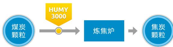
为了确保最终产品焦炭的品质，精确控制水分含量十分必要。这是工艺监测与控制的一项重要任务。水分检测系统的安装主要用于调节炼焦炉，使之确保能够连续稳定的生产焦炭。对于干燥器的调节作用：如果输入的煤炭过于干燥，则在装运煤炭以及车间后期形成的粉尘会过多。粉尘的形成将导致清洁成本和过滤设备成本增加。只有通过精确的在线水分检测和受控的干燥工艺才能确保产品的水分含量保持最佳和稳定状态。
