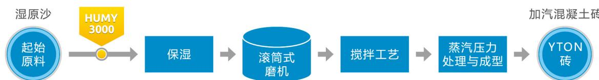
在加气混凝土砖生产中,精确监测和控制粗砂中携带的水分是生产工艺的一项重要任务。只有通过精确在线水分检测和受控保湿工艺才能确保砂的磨削工艺保持最佳稳定状态。
