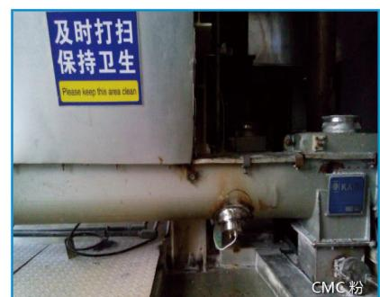
将湿度传感器安装在螺旋传送机上是非常合适的，因为被测物料被螺旋叶片连续不断的导向传感器，且物料相对均匀一致。湿度传感器须安装在螺旋传送机的下面。
