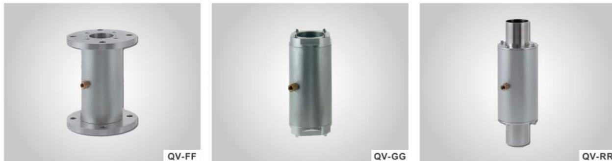
通过介质压力 / 工作压力的 2~3bar 的压差(根据弹性体的质量而定)作用, 气动式挤压阀 QV 被关闭。当压力供应中断并且挤压阀阀体通气时, 挤压阀内衬套由于其极大的回弹力而完全打开。
