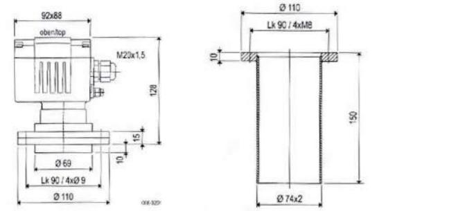
隔膜式料仓压力开关是在气动式填充过程中防止料仓压力过高而遭到破坏的保护设备。
