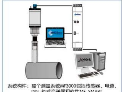
系统构件：整个测量系统MF3000包括传感器、电缆、DIN-轨式变送器和软件MF-SMART
