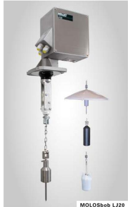
与钢带相连的重量传感器下放到料仓或筒仓内, 在重锤碰到物料表面时拉力减弱。通过钢带 LJ20 的电子元件会很快识别出变化, 停止重锤下放。与测得的距离成正比例发出一个 4~20mA 的测量信号, 重锤重新返回到上部位置。直到下一次测量, 这次的测量值仍被保存。
